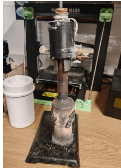
4 Erster Prototyp des Reaktors, geplatzt und mit der ersten Heizkammer verschmolzen.
